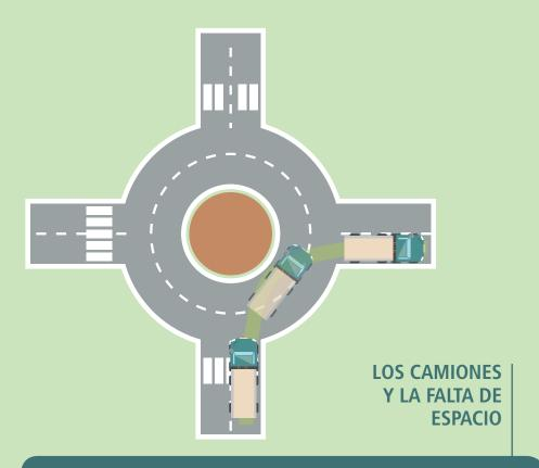
Si el conductor de un camión de grandes dimensiones se ve obligado a abrise hacia la izquierda antes de entrar en una glorieta, o invadir un segundo carril dentro de ella para que la parte posterior del semirremolque no suba al bordillo, deberás respetar la prioridad de los conductores que circulan por el carril que necesita ocupar e indicar, primero con el intermitente izquierdo ese desplazamiento, y después con el derecho el cambio de dirección a la derecha.
