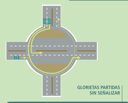
Disponen de dos tramos, generalmente opuestos, que se conectan directamente a través de una isleta central de manera que el tráfico pasa de un lado a otro y no la rodea. Si no cuenta con señalización, rige la regla general de prioridad de la derecha.
